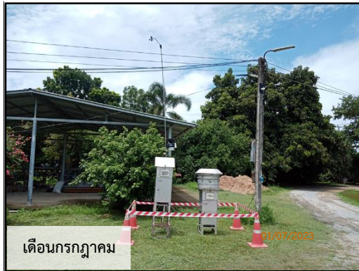
ภาพที่ 3.2 การตรวจวัดคุณภาพอากาศในบรรยากาศ บริเวณชุมชนบ้านชอมตะวันออก
